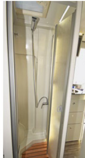
Mit dem zusätzlichen Duschkopf-Halter (rechts) steht wieder die gesamte Stehhöhe der Nasszelle zur Verfügung.
